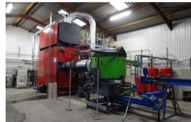
Centrale biomasse associée à un sécheur
