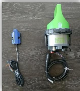
Capteur magnétique ou inclinomètre + transmission via réseau IoT -> information sur l'ouverture des vannes
