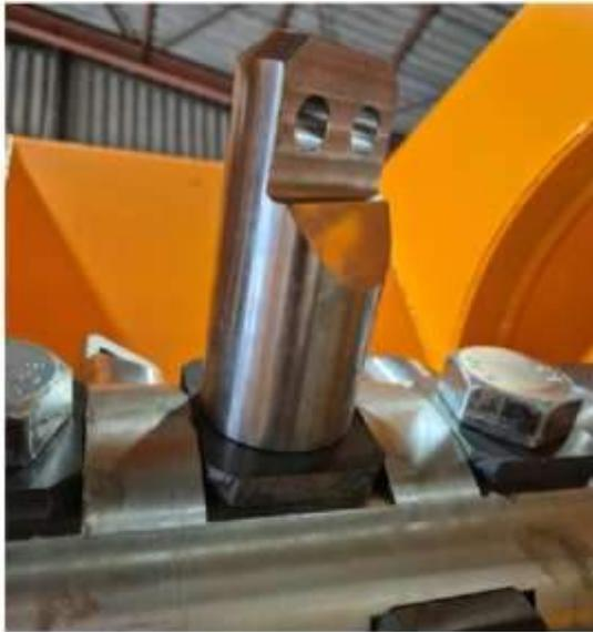
Sur ce rotor, sont montés **36 marteaux**. Ils sont chacun équipé d'une **tête de frappe** de **225cm<sup>2</sup>** et de **8mm à 20mm** d'épaisseur en acier anti-abrasion Hardox 500. C'est cet ensemble de marteaux montés sur le rotor et tournant jusqu'à **600 tr/min**, à l'aide d'un moteur de 55kW, qui assure l'ouverture et le nettoyage des emballages.
