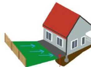
Face à un terrain en pente et un pourtour nu exposé, appliquer les recommandations nécessaires pour l'**amplification horizontale périphérique** et de **drainage des eaux adéquat**
